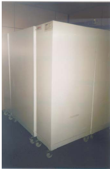
Depósitos de agua borada cerrando el blindaje del prototipo
