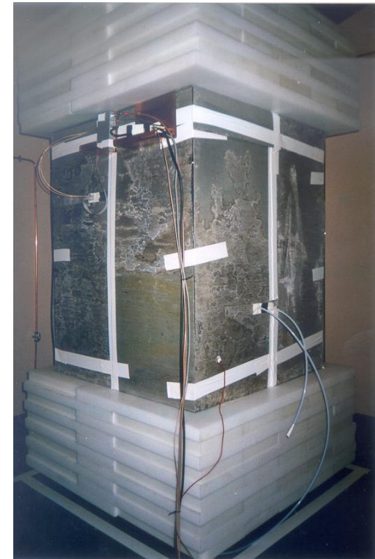
Láminas de cadmio y polietileno en el blindaje del prototipo
